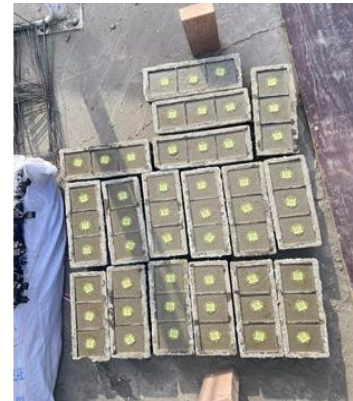
随车单对照、砼浇筑时塌落度检测和试块的留置
