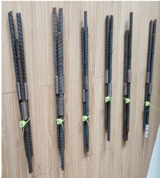
机械连接现场取样送检、砼试块留置
