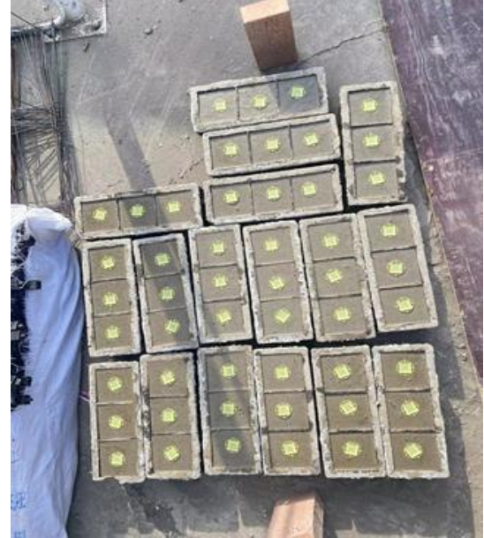
机械连接现场取样送检、砼试块留置
