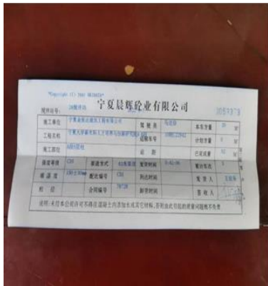
随车单对照、砼浇筑时塌落度检测和试块的留置
