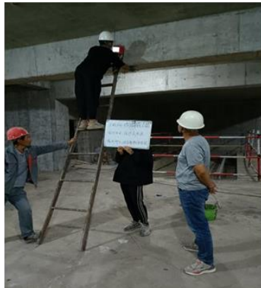
钢筋保护层厚度检测
