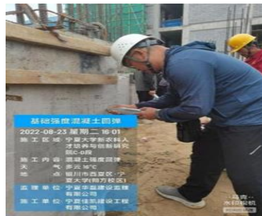
回弹基础承台混凝土强度
