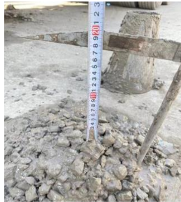
随车单对照、砼浇筑时塌落度检测和试块的留置
