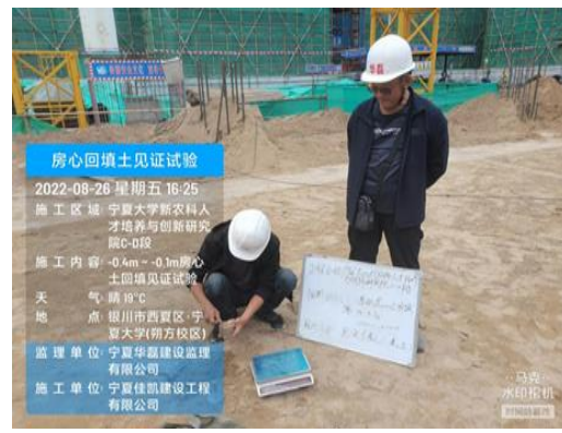
房心土回填压实度常规、见证试验
