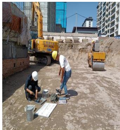
灌砂法压实度检测，素土、2:8 灰土环刀法检测
