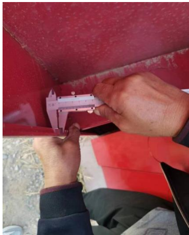
消防箱进场检测
