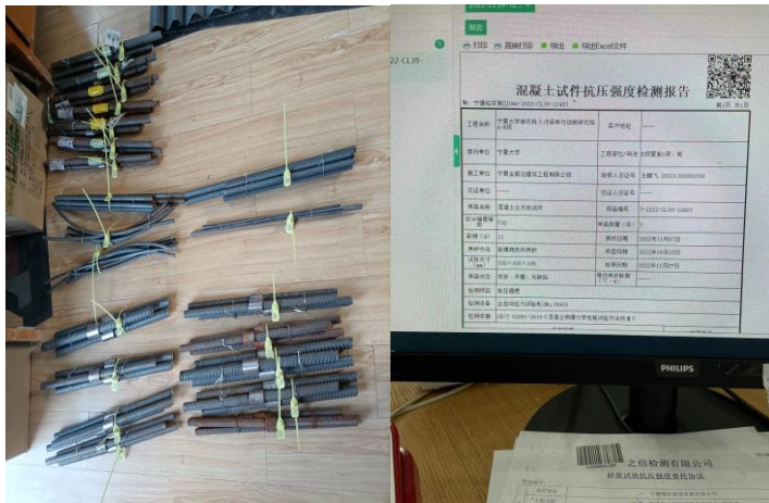
钢筋原材、机械连接及拆模试块送检
