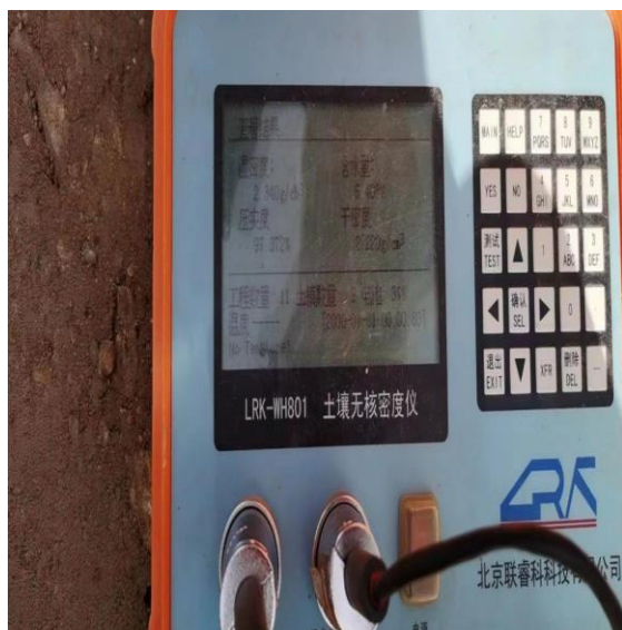
砂夹石压实度土壤无核密度仪检测
